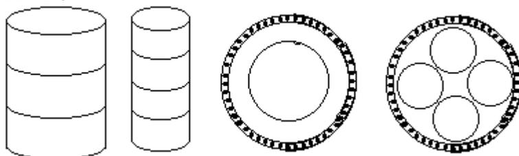
由于热值与其质量成正比，相同质量的蜂窝煤应该产生相同的热值，所以要砌放 3 块大蜂窝煤的炉灶，也可以砌成能放 16 块小蜂窝煤的炉灶，如同图上所示的两种炉膛内的蜂窝煤全部燃烧（令中间小孔不计），其燃烧面积应该是上端面的面积加上侧面的面积之和，于是，对于 16 块小蜂窝煤，燃烧表面积之和为：
