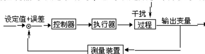
图 5-15 反馈控制流程图
