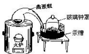
图2—2 拉瓦锡研究空气成分所用的装置
