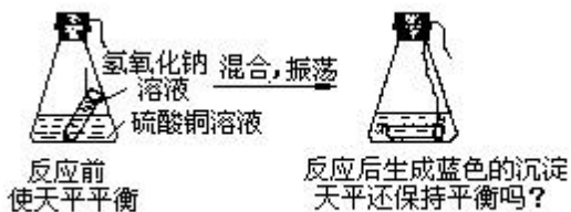
图4—13 称量氢氧化钠溶液、硫酸铜溶液反应前后质量有无变化
