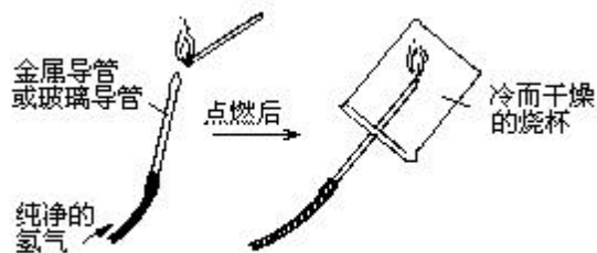
图6-8 氢气在空气里燃烧
